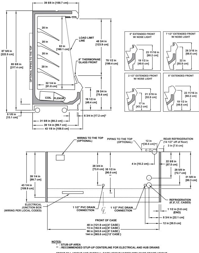
FRONT SILL HEIGHT AND OVERALL CASE HEIGHT VARIES WITH BASE FRAME HEIGHT ENDS ADD APPROXIMATELY 1" TO CASE HEIGHT WIRING-TO-THE-TOP ADDS APPROXIMATELY 1" TO CASE HEIGHT A 2" MINIMUM AIR GAP IS REQUIRED BETWEEN THE REAR OF THE CASE AND A WALL
